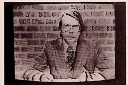
Bild 9. Falsch eingestellte Klemmung
