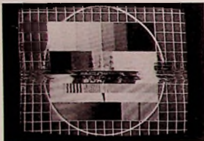
Bild 16. Rhythmisch verlaufende Störzone bei Servofehlern
